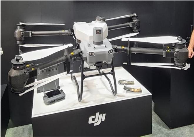
Die Agras T50 von [Globeflight](#) hebt die landwirtschaftlichen Drohneneinsätze auf ein neues Niveau. Sie verfügt über ein leistungsstarkes Antriebssystem und eine drehmomentfeste Struktur für höchste Stabilität beim Tragen von 40 kg Sprüh- oder 50 kg Streuladung.
