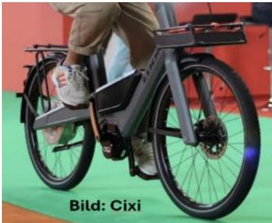
Jede Menge von **eBikes** in verschiedenen Hallen, aber die echte Neuheit wie das **ROVER 45 von Look und Cixi** wurde nicht gesehen. Dies sind die ersten eBikes ohne Kette und Riemen. Der Antrieb erfolgt über einen Hybrid-Antrieb. Die Tretkraft wird an einen Generator weitergeleitet, der über den Zwischenspeicher Batterie den Motor und damit das E-Bike antreibt. Auch eine Energie-Rückgewinnung beim Bergab fahren oder Bremsen (Rekuperation) wie beim E-Auto ist mit diesem System möglich.
