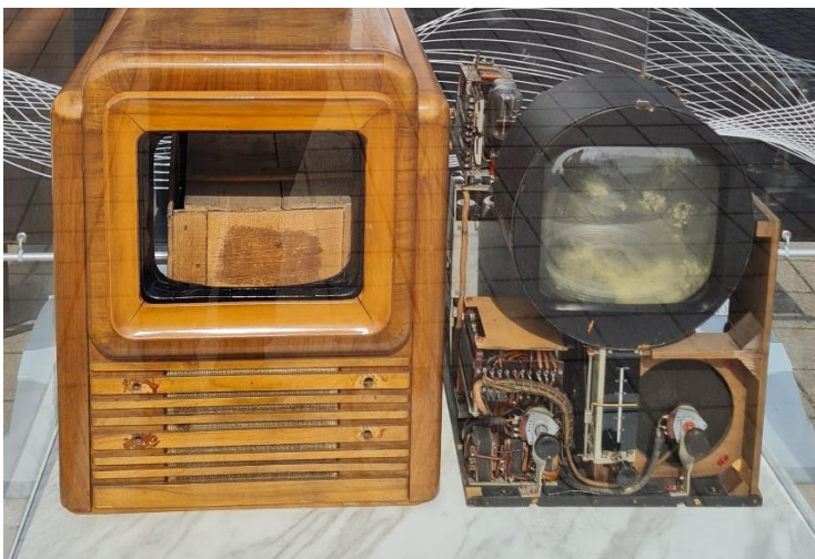
Da hat's noch richtig «gefunkt»: LOEWE's erster Prototyp TV für Massenfertigung in den frühen 1930er Jahren, inklusive Bildröhre alles «Made in House by LOEWE» ausgestellt vor dem Haupteingang Süd! (240 Zeilen /25 Hz ) Gegründet wurde die LOEW-Audion GmbH 1923 in Berlin. Mehr zur Firmengeschichte WIKIPEDIA .
