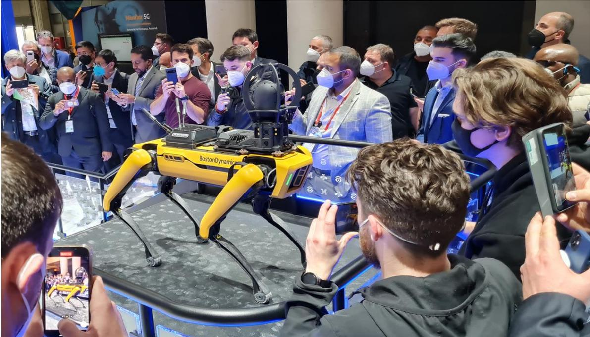
Der absolute Star bei Live Demos von IBM/Boston Dynamics. Spot ist ein agiler «hundeähnlicher» mobiler Roboter, der mit beispielloser Mobilität durch Gelände navigiert und es ermöglicht, routinemässige Inspektionsaufgaben und Datenerfassung, sicher, genau und häufig zu automatisieren. Fernsteuerbar bis 30Km mit viel AI und super Robotics. Mehr zum SPOT-Projekt gibt's bei [IBM hier](#).
